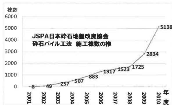
図-14 砕石パイル施工実績
